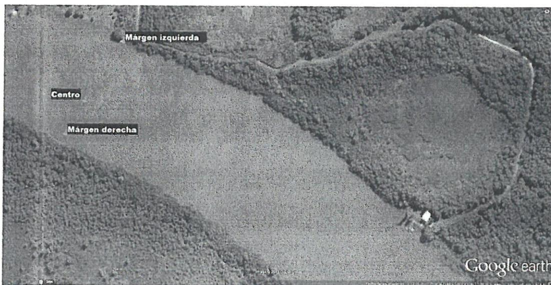
En cada punto de muestreo se realizan determinaciones con la sonda multiparamétrica de CARU a tres profundidades diferentes (0.3, 1.0 y 3.0 m, este último cuando la profundidad del río así lo permite) y se extraen alícuotas a 1.0 m de profundidad para componer la muestra que posteriormente se analiza en laboratorio. Las sondas o multímetros son facilitados por la CARU a la SAER ya calibrados y se verifican previo a su uso.
