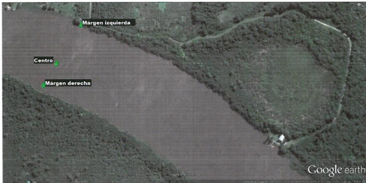
En cada punto de muestreo se realizan determinaciones con la sonda multiparamétrica de CARU a tres profundidades diferentes (0.3, 1.0 y 3.0 m, este último cuando la profundidad del río así lo permite) y se extraen alícuotas a 1.0 m de profundidad para componer la muestra que posteriormente se analiza en laboratorio. Las sondas o multímetros son facilitados por la CARU a la SAER ya calibrados y se verifican previo a su uso.
